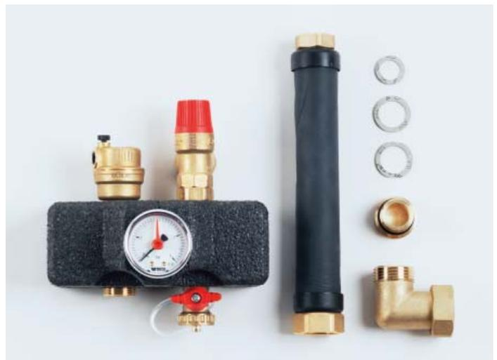
**Komplett vormontierte Kesselsicherheitsgruppe** mit Manometer, Schnellentlüfter (beide mit automatischer Absperreinrichtung), KFE Hahn und Sicherheitsventil
