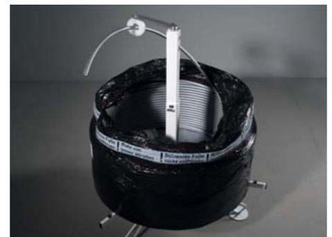
An die jeweilige Rohrverpackung (Spezialkarton bzw. spezielle Stretchfolienverpackung) in der Höhe anpassbarer Rohrführungsarm.
