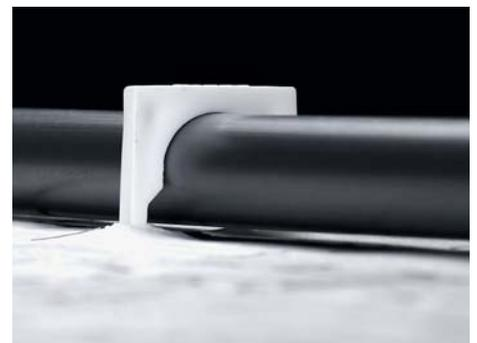
Die vier Widerhaken des Rohrankers sorgen für den optimalen, oberflächennahen Halt des Rohres auf der Tackerdämmung. Somit sind nur wenig Millimeter Bewegungsspielraum vorhanden, auch bei Zugbelastung.
